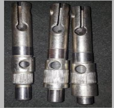
Ceiling Fan Shaft
