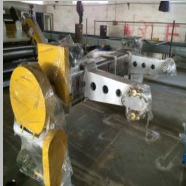
Shaftless Electric Mill Roll Stand
